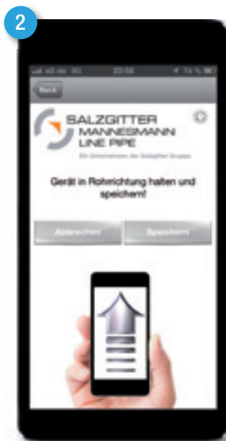
2 Mithilfe der Kompassfunktion kann jedes Rohr mit GPS-Daten geografisch verrortet werden. Während der Erfassung werden die Rohrnummern geprüft. So besteht bereits beim Scan die Möglichkeit, Schnittrohre zu erfassen oder das Rohrlager zu aktualisieren.
