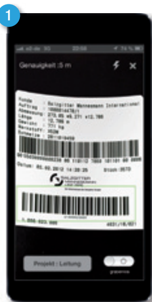
1 Mit der Kamera erfolgt die Barcodeerfassung zur eindeutigen Kennzeichnung und Rückverfolgbarkeit jedes einzelnen Rohres
