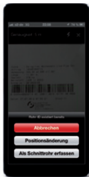
2 Mithilfe der Kompassfunktion kann jedes Rohr mit GPS-Daten geografisch verrortet werden. Während der Erfassung werden die Rohrnummern geprüft. So besteht bereits beim Scan die Möglichkeit, Schnittrohre zu erfassen oder das Rohrlager zu aktualisieren.
